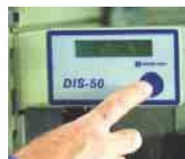
**Информационные системы поставок топлива позволяют автоматизировать долив топлива в резервуар с получением точных данных по поставкам и контролируя состояние резервуара.**
